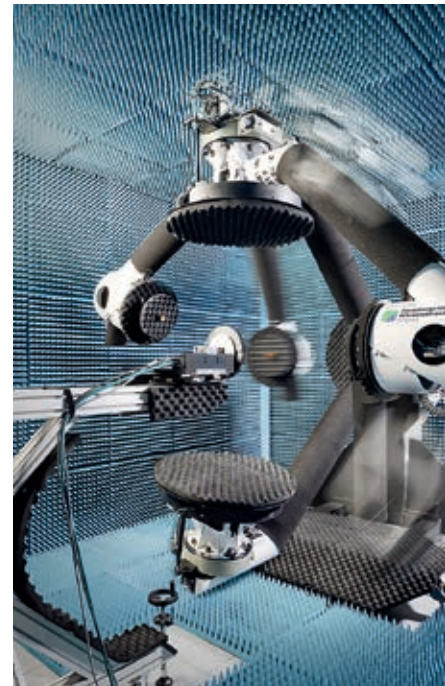
Automatisierter Antennenmessplatz für Nah- und Fernfeldmessungen bis 325 GHz
