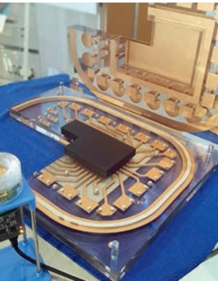
Kleiner Sensor ganz groß – für den MST-Kongress wurden die winzigen Strukturen des GlaRA-Radarsensors augenfreundlich auf einem Modell visualisiert
