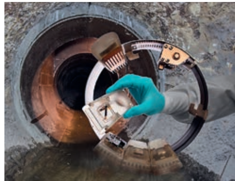
Links: Energieautarkes Sensorsystem für die Überwachung von Umweltparametern in Abwasserkanälen
