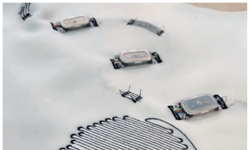
Unten: Aktuelle Gehäusevariante auf einer Bionic RoboSkin Sensorhaut montiert von Projektpartner TITV
