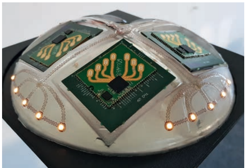
Aufbau einer Deckenlampe aus Polyurethan mit vier Radarmodulen
