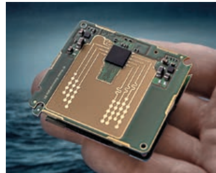
Radars-Frontend für ein hochauflösendes Radarsystem mit KI-gestützter Datenverarbeitung für kooperatives autonomes Fahren
