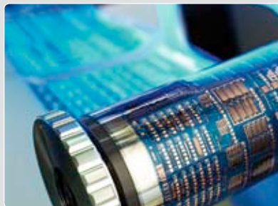
Fertigung polymerelektronischer Schaltkreise von Rolle zu Rolle
