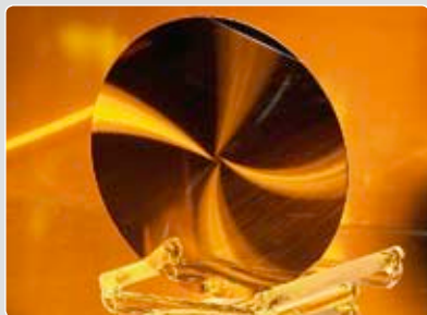
Mobiler elektrostatischer Träger mit gedünntem Wafer
