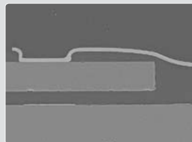
Schliff von TCI (SEM) (Chips 40 µm dünn)
