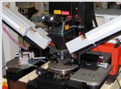
Höchstfrequenzmessungen an einem Verstärker bis 110 GHz
