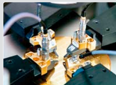
4-Port-Messplatz zur HF-Charakterisierung gekoppelter Strukturen bei differentieller Anregung
