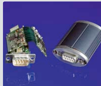
Realisierung eines Messmoduls mit galvanischer Trennung (Quelle: imc Berlin)
