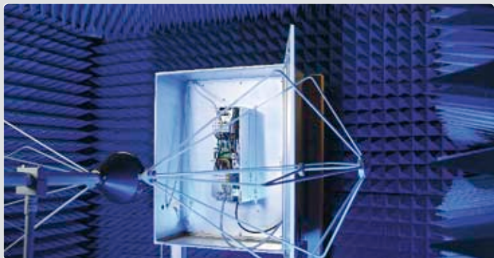
Testaufbau am EMV-Messplatz in der Absorberkammer
