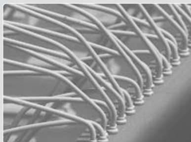
Ball Wedge Wire Bonding mit Ultra Fine Pitch < 50 \mu\text{m}
