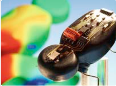
Mini-Roboter als Rapid Prototyping 3D MID-Modul
