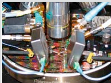
Aufbau zur ESD-Belastung und Messung von Hochfrequenzparametern bis 10 GHz
