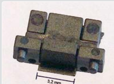
Optisches Koppelmodul zur 90° Lichtumlenkung für elektro-optische Leiterplatten und optische Backplane mit lasergeschriebenen Wellenleitern
