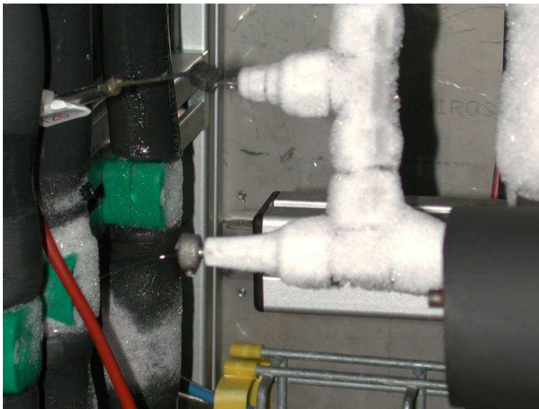
Bild 3: Faserzuführung zur Temperaturmessung in einer Mikroreaktions- kammer der Firma BAYER Technology Services.
