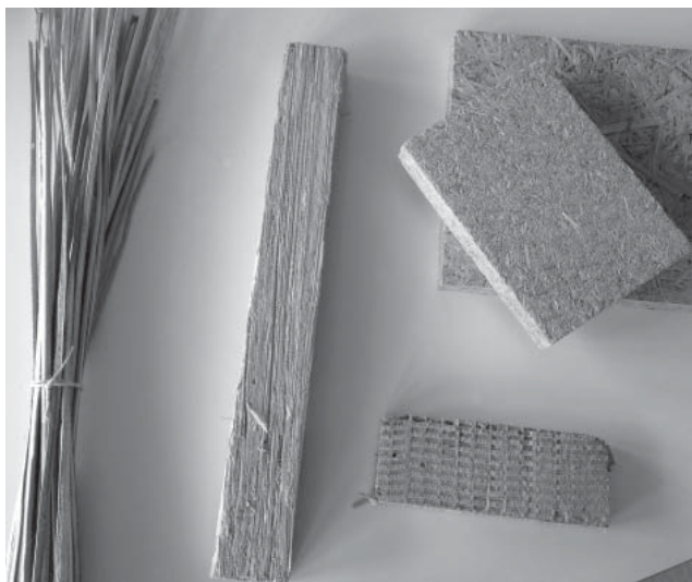
Rohrkolben (Typha) in seinen unterschiedlichen Verarbeitungsstufen. Rechts oben ist die Dämmplatte zu sehen. (© Fraunhofer IBP) | Bild in Farbe und Druckqualität: www.fraunhofer.de/presse
