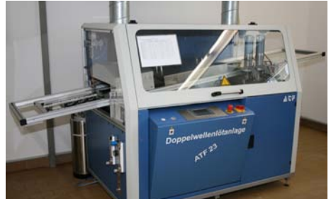
ATF Doppelwellenlötanlage N2
