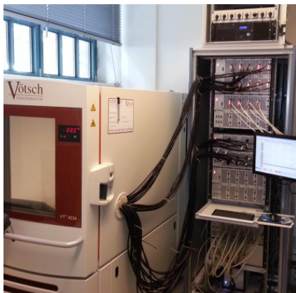
Batteriemessplatz mit Temperaturkammer und EIS
