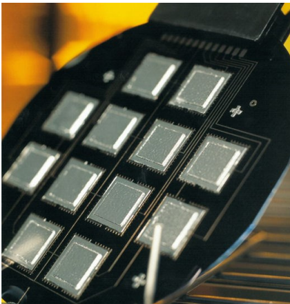
Wafer mit am IZM entwickelten Mikrobatterien
