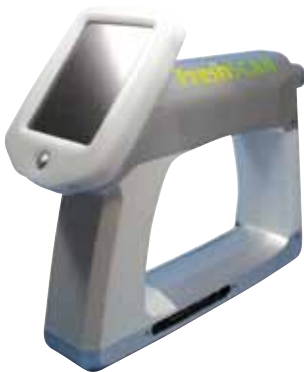
Funktionsdemonstrator zur spektraloptischen Messung der Lebensmittelbeschaffenheit
