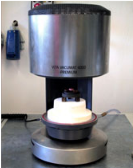
Löten der Demonstratoren im Vakuum
