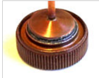
Löten der Demonstratoren im Vakuum
