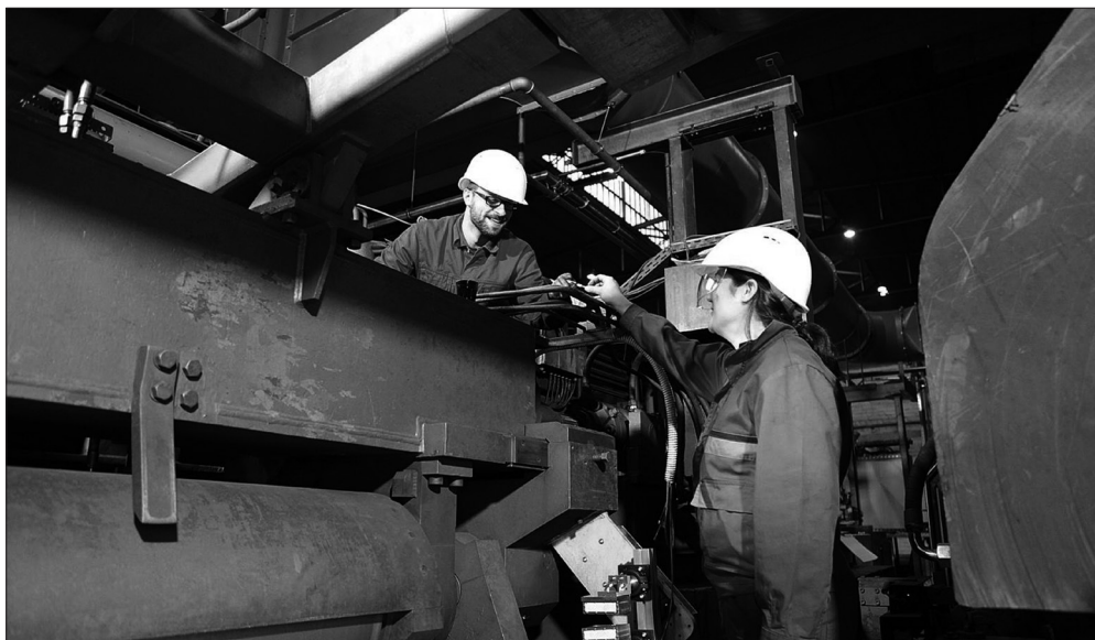
Forscher des Fraunhofer FHR installieren das Radar in einem Bandwalzwerk in Eisenhüttenstadt. (© Fraunhofer FHR) | Bild in Farbe und Druckqualität: www.fraunhofer.de/presse
