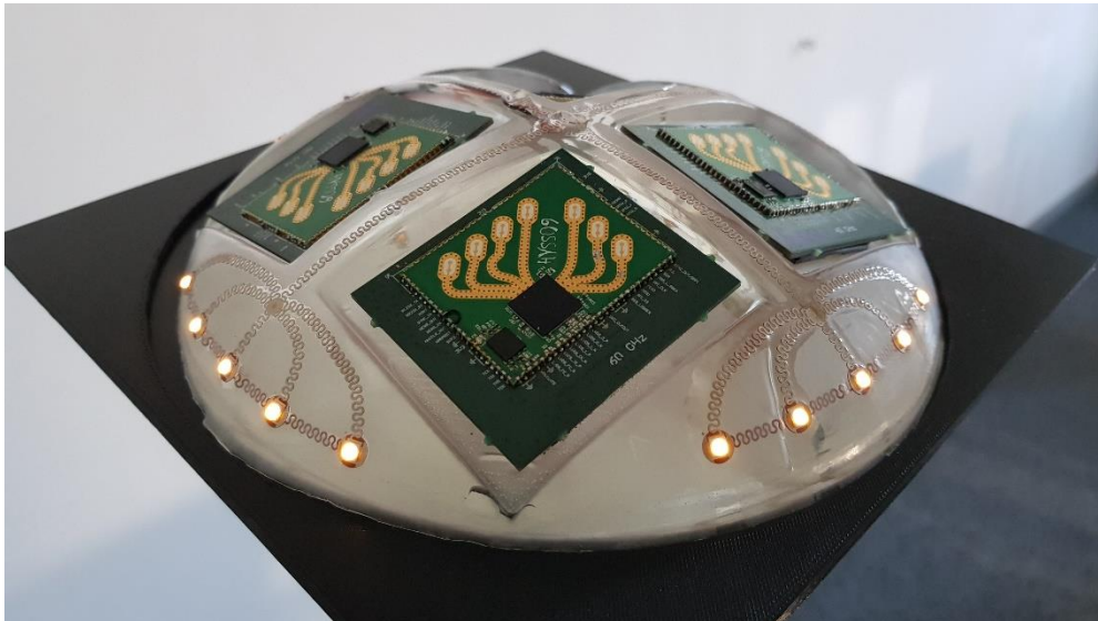
Aufbau der Deckenlampe aus Polyurethan mit vier Radarmodulen
