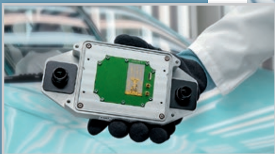
Radar-Sensor-Modul für autonomes Fahren
