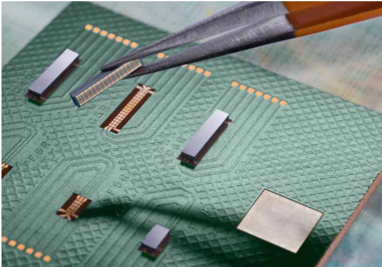
GaN-SMPT-Testchip mit nanoporösem Gold für die Flip-Chip-Montage auf PCB-Testplatine
