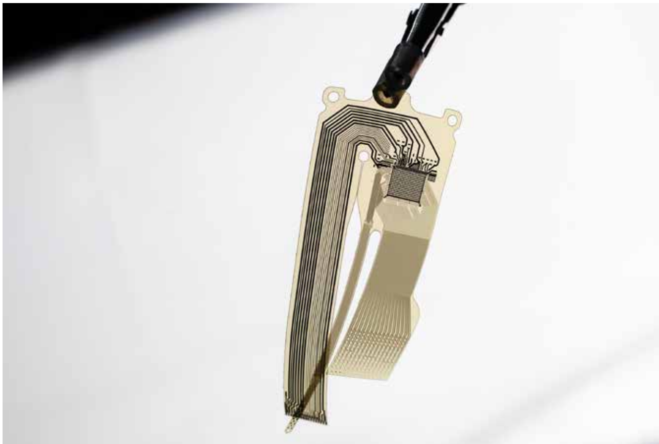
Flexibles Substrat auf Dünnschichtbasis für epi- und subkortikale Anwendungen
