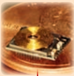
Mit der University of Utah entwickelte drahtlose neuronale Schnittstelle
