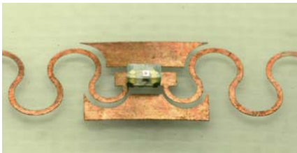
Zugsperrn im Kupfer unterdrücken die Elastizität am Übergang vom dehnbaren Substrat zu den starren Einzelkomponenten
