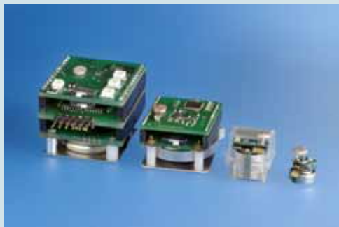
Integrationsstufen der eGrain Hardware-Plattform auf der Basis diverser IZM-Technologien
